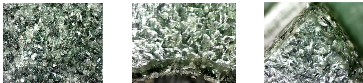
Рисунок 9 – Структура напечатанных образцов с карбида кремния SiC
