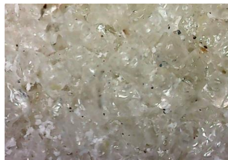
Рисунок 2 – Структура шлифовальной головки из электрокорунда белого на керамической связке
