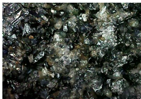
Рисунок 1 – Структура шлифовального круга из карбида кремния на керамической связке
