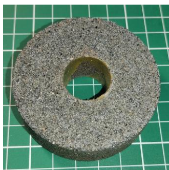
Рисунок 1 – Структура шлифовального круга из карбида кремния на керамической связке
