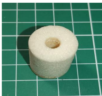
Рисунок 2 – Структура шлифовальной головки из электрокорунда белого на керамической связке
