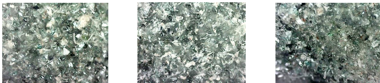
Рисунок 8 – Структура образцов с карбидом кремния SiC, полученных в матрицах
