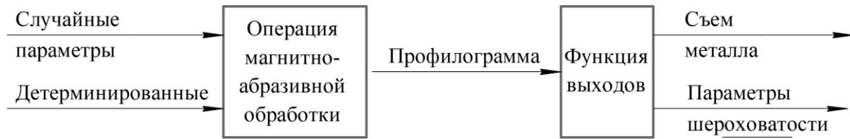
Рисунок 1 – Системный анализ операции магнитно-абразивной обработки
