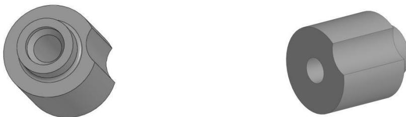
Радиус в основании выступа образован за счет геометрии металлорежущего инструмента
