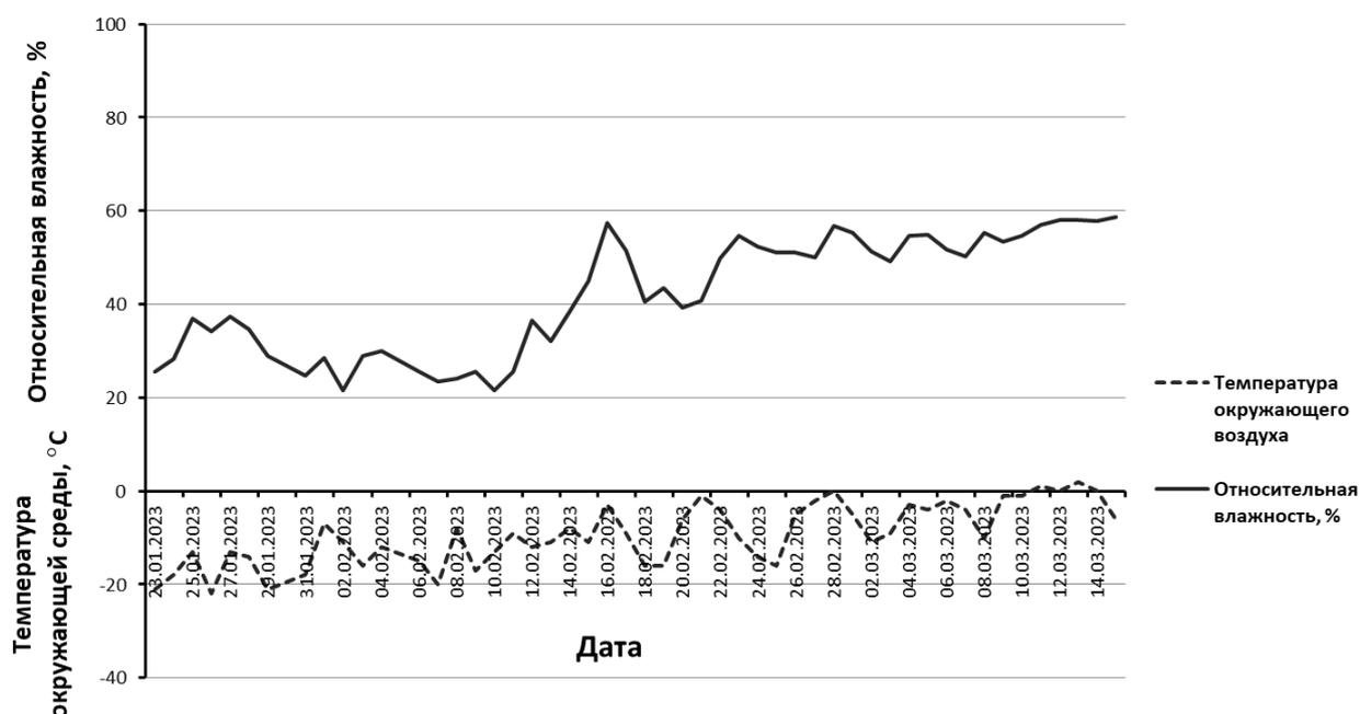
Рисунок 7 – Результаты сравнительного анализа изменения относительной влажности воздуха в помещении крытой стоянки и температуры окружающей среды
