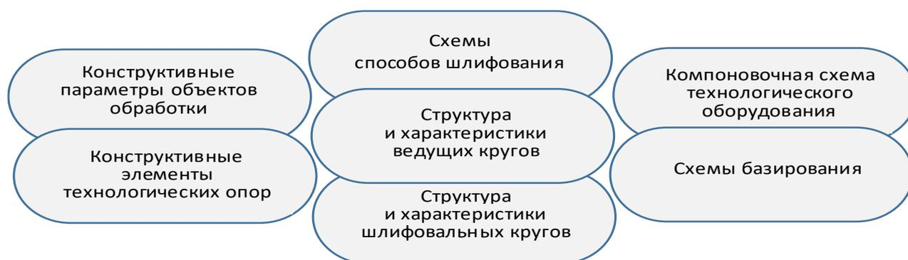
Рисунок 1 – Конструкторско-технологические признаки способов бесцентровой шлифовальной обработки
