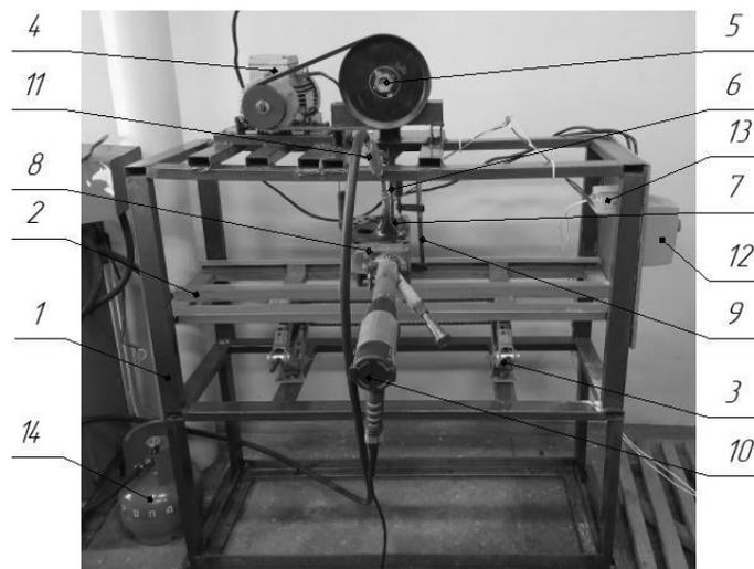
1 – рама, 2 – регулируемый по высоте стол, 3 – подъемный механизм, 4 – асинхронный электродвигатель, 5 – кулачковый привод толкателя, 6 – толкатель, 7 – выпускной клапан, 8 – головка блока цилиндров, 9 – струбцина, 10 – фен промышленный, 11 – горелка газовая, 12 – магнитный пускатель, 13 – терморегулятор, 14 – баллон газовый
