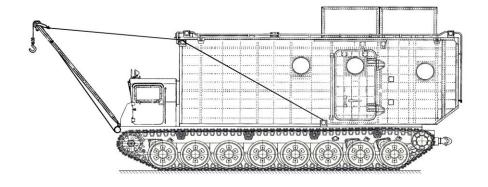
Рисунок 10 – Размещение крана – стрелы на тягаче
