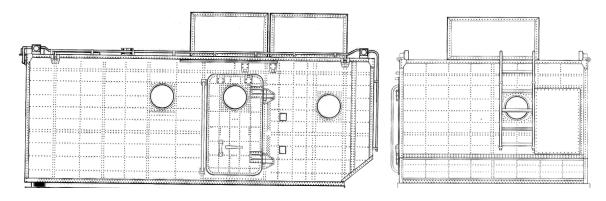
Рисунок 9 – Герметичный жилой модуль тягача
