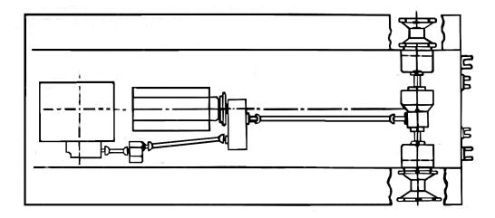
Рисунок 2 – Компоновка механической трансмиссии с задней ведущей звездочкой
