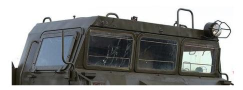
Рисунок 4 – Кабина с отрицательным наклоном лобового стекла
