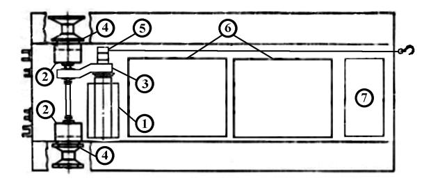
1 — двигатель; 2 — бортовая коробка передач; 3 — входной редуктор; 4 — бортовая передача; 5 — основная лебедка; 6 — топливные баки; 7 — масляный бак
