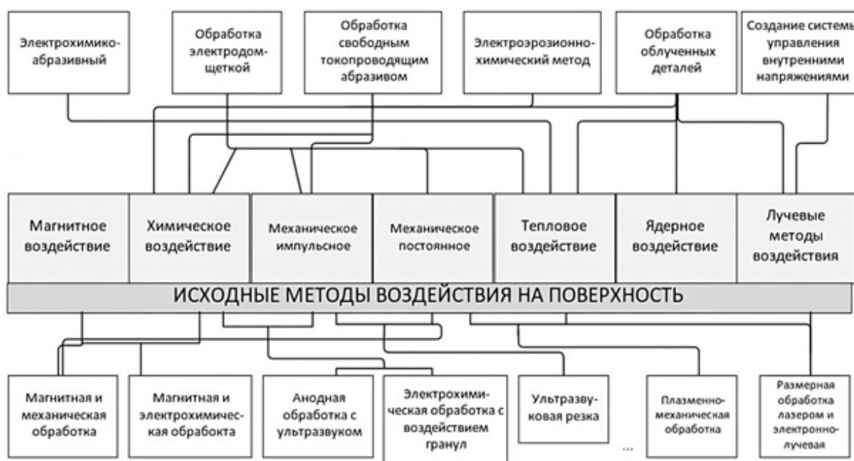
Рисунок 1 – Классификация методов воздействий и комбинированные методы обработки, применяемые в технологических комплексах
