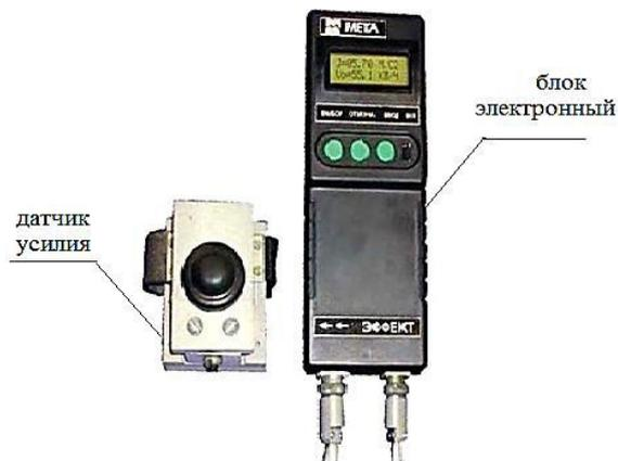
Рисунок 7 – Контрольно-измерительный прибор «Эффект-02»
