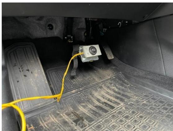
Рисунок 8 – Установленный на автомобиле прибор «Эффект-02»
