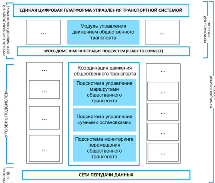
Рисунок 1 – Архитектура модуля управления движением общественного транспорта [7]
