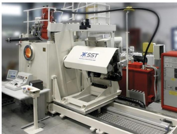
Рисунок 2 – Установка фирмы Steigerwald с многокоординатным ЧПУ для перфорирования плоских металлических заготовок электронным лучом
