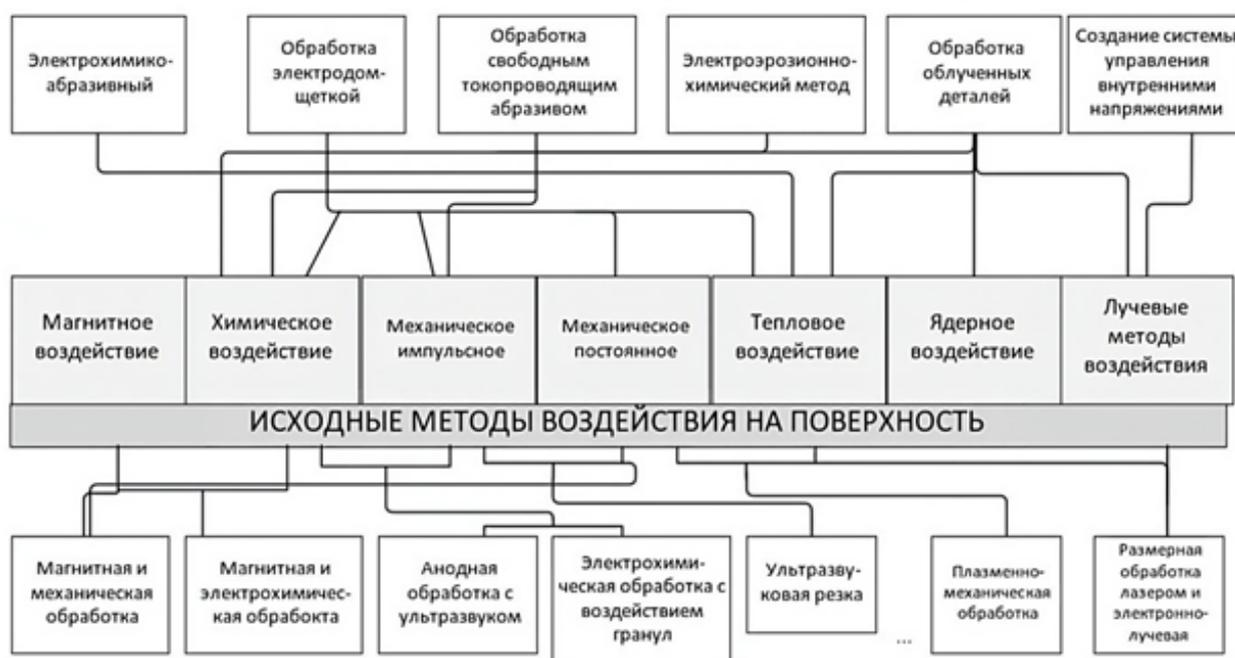
Рисунок 1 – Классификация методов воздействий и комбинированные методы обработки, применяемые в технологических комплексах
