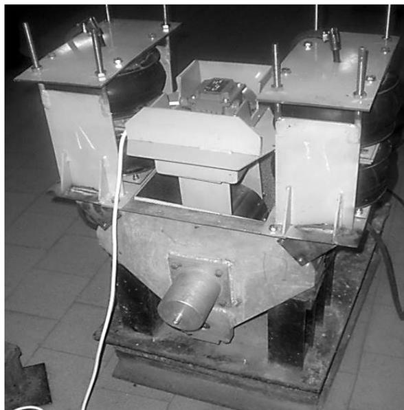
Рисунок 3 – Экспериментальный образец виброупрочняющего устройства с двухмассовой системой
