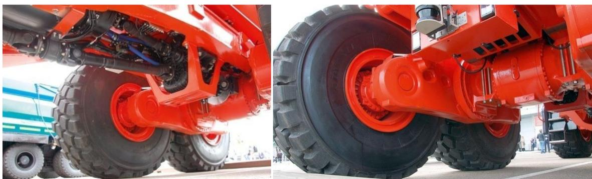
Рисунок 7 – Тандемный мост полноприводного самосвала
