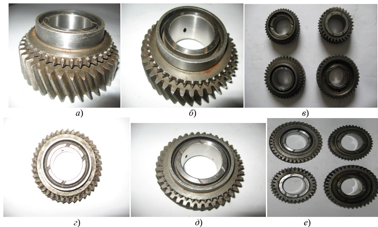
a – первая ступень; б – вторая ступень; в – третья ступень (два комплекта); г – задняя передача, д – ступени постоянного зацепления; е – пятая передача
