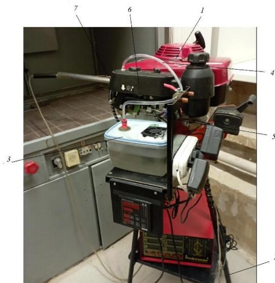
1 – двигатель внутреннего сгорания; 2 – рама; 3 – парогенератор;
