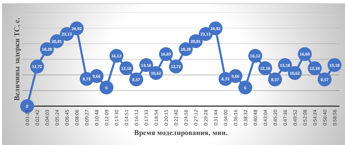
Рисунок 1 – Изменение величины задержки транспортных средств, левый поворот осуществляется из общей полосы
