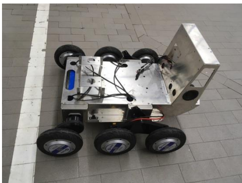
Рисунок 1 – Примеры современных беспилотных транспортных средств, оснащённых бортовой системой поворота
