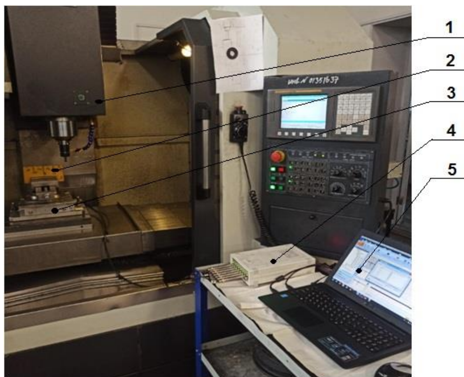
1 – обрабатывающий центр с системой ЧПУ; 2 – корпусная деталь из стеклопластика (образец); 3 – динамометр; 4 – устройство сопряжения; 5 – компьютер
