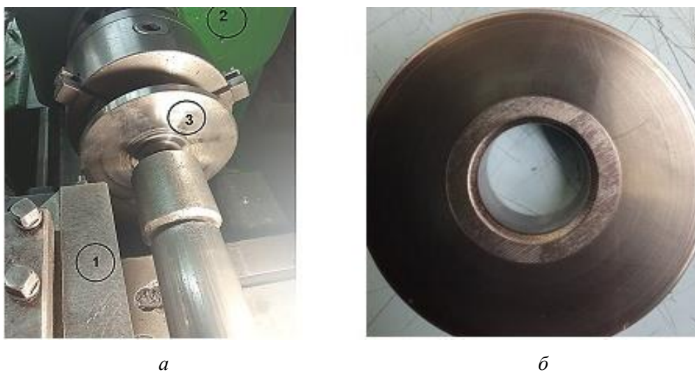
а б 1 – пружинный алмазный выглаживатель, 2 – токарный станок, 3 – лабораторный образец с керамическим покрытием
