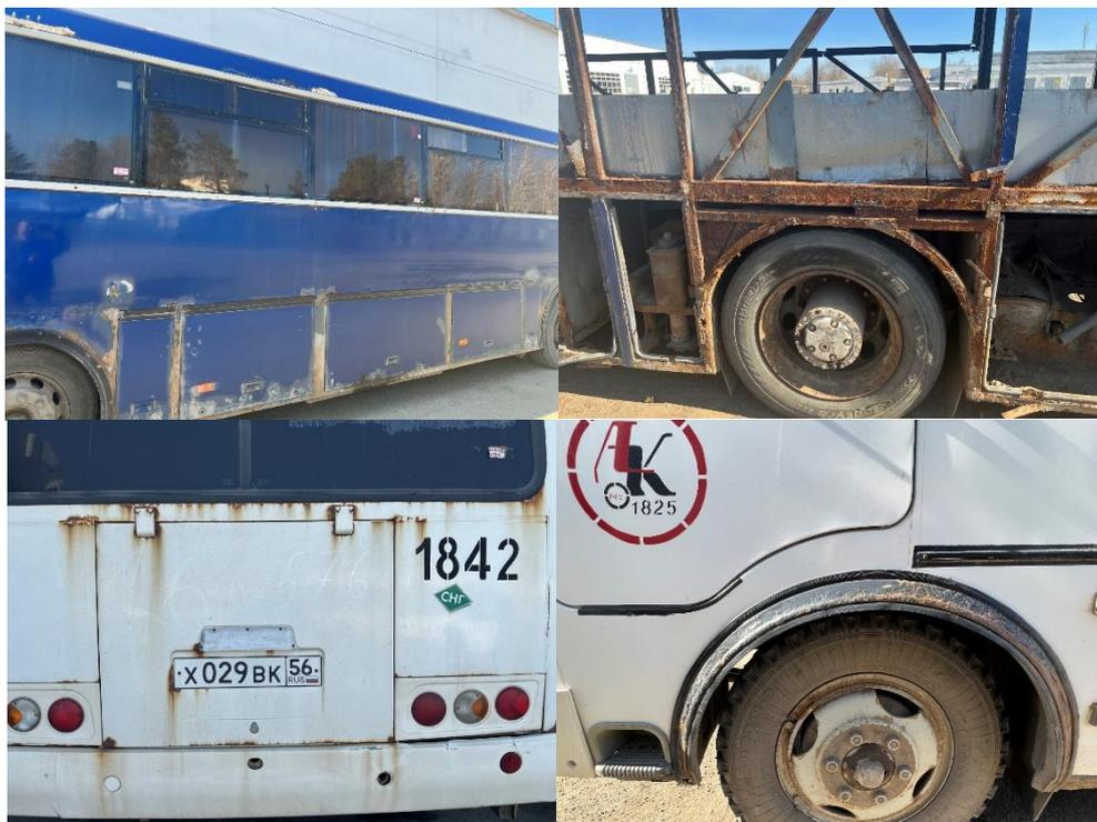
Рисунок 1 – Внешний вид коррозионных повреждений кузовов автобусов
