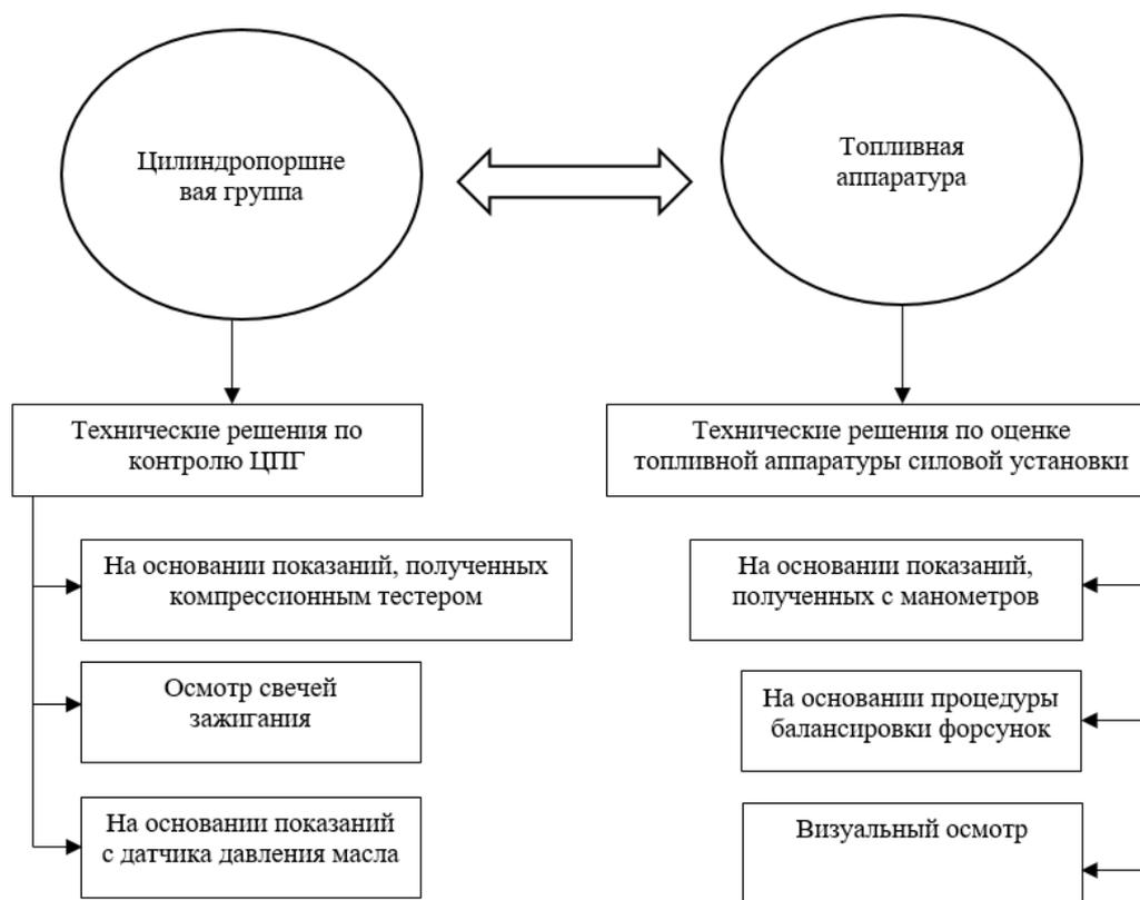
Рисунок 1 – Технические решения, применяемые для оценки цилиндропоршневой группы силовой установки и контроля топливной системы транспортных средств (составлено авторами)
