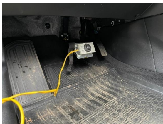
Рисунок 8 – Установленный на автомобиле прибор «Эффект-02»
