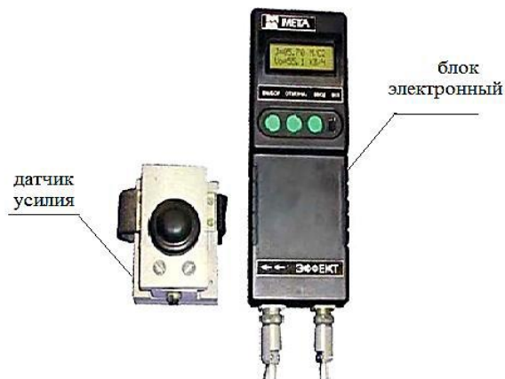
Рисунок 7 – Контрольно-измерительный прибор «Эффект-02»
