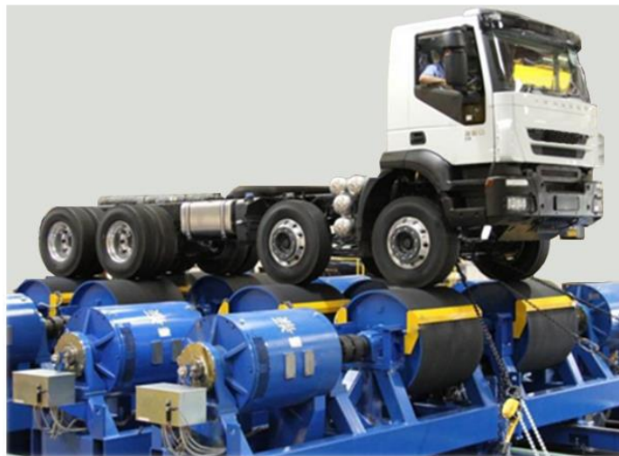
Рисунок 9 – Общий вид барабанного испытательного стенда
