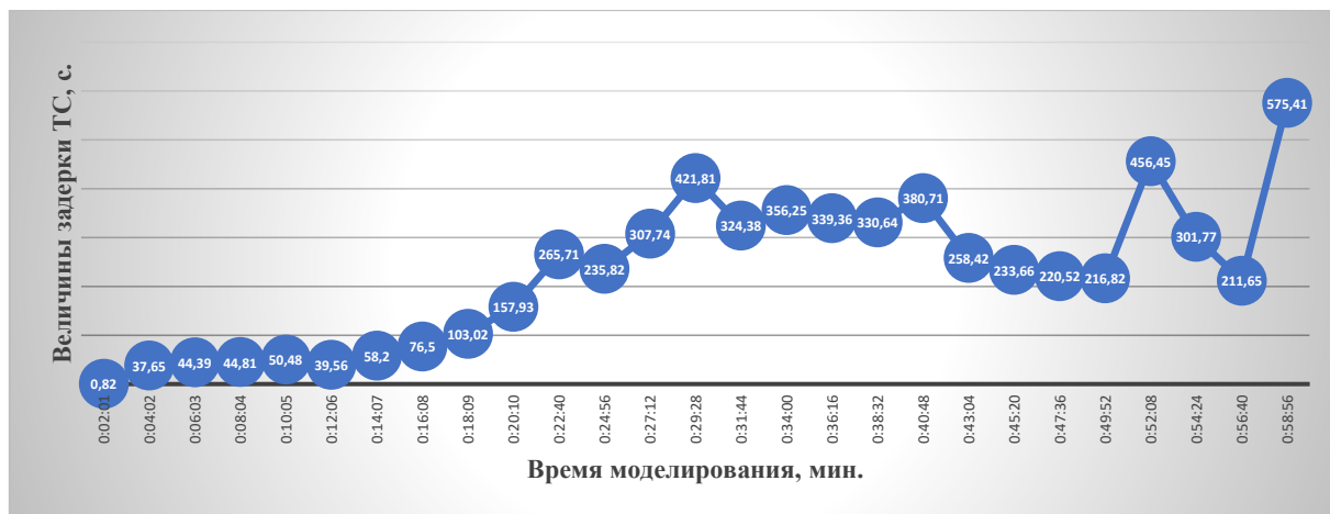
Рисунок 2 – Изменение величины задержки транспортных средств с выделением специализированной полосы, но без обособленной фазы
