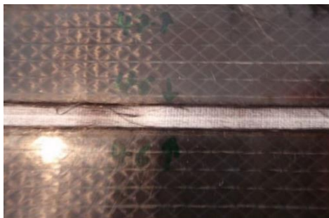
Рисунок 3 – Образец тестовых резов углепластика при скорости резки 2,5 м/мин
