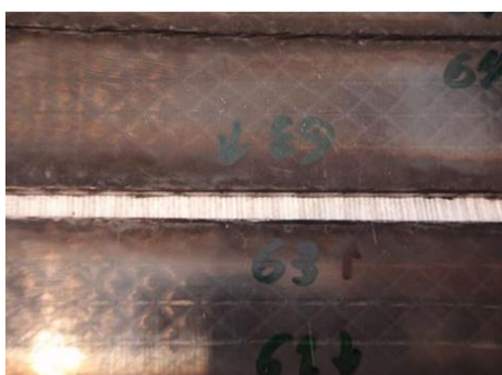
Рисунок 8 – Результат обработки углепластика с использованием сопла диаметром 2 мм и 3-мя проходами
